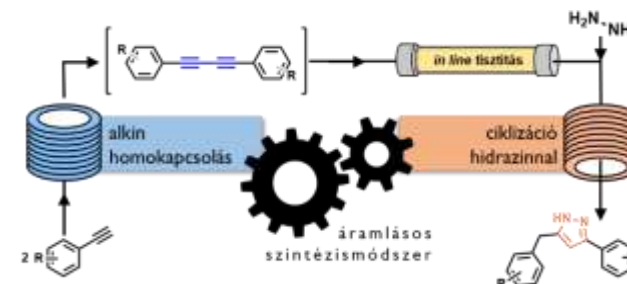
3. ábra: 3,5-diszubsztituált pirazolok szintézise kétlépeses áramlásos rendszerben.
