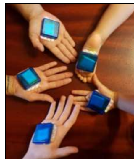
Az Obimon - elektrodermális aktivitás mérő készülék, melyet az arousal mérésére használtam. Forrás: obimon.com
