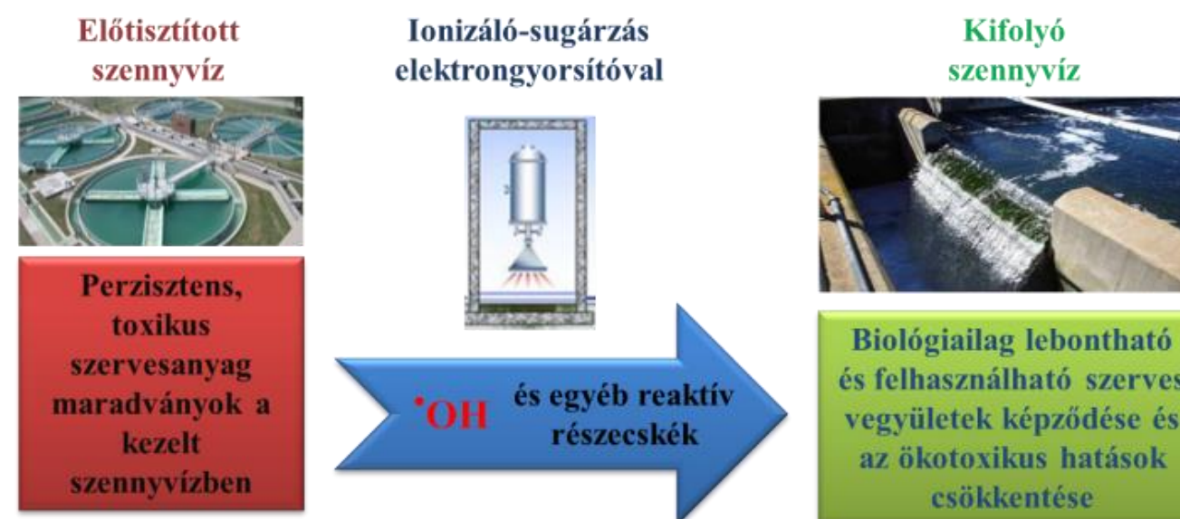
1. ábra A hagyományos szennyvíztisztító eljárások után kapcsolt ionizáló sugárzásos szennyvíztisztítási módszer működése és várható környezeti hatásai
