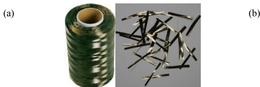
A vulkanikus eredetű bazaltkőből készített bazaltszövet mint nagy szilárdságú erősítőanyag; roving (a) és vágott szál (b)
