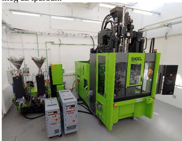
2. ábra T-RTM berendezés (jobb oldalt: 2K vertikális fröccsöntőgép, bal oldalt hátul: T-RTM egység)
