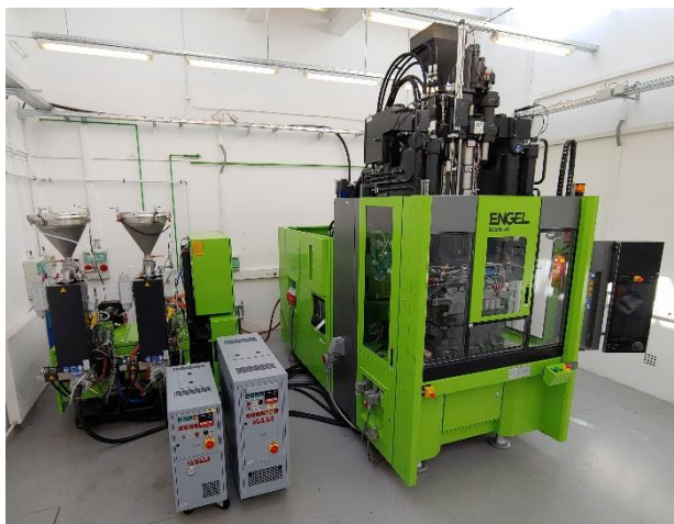
3. ábra T-RTM berendezés (jobb oldalt: 2K vertikális fröccsöntőgép, bal oldalt hátul: T-RTM egység)
