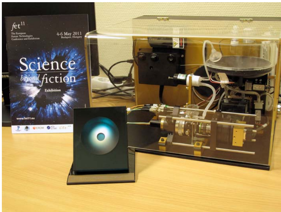
Az MTA Számítástechnikai és Automatizálási Kutató Intézete által kifejlesztett és a Feltörekvő Technológiák Európai Konferenciáján díjnyertes digitális holografikus mikroszkóp (DHM)
